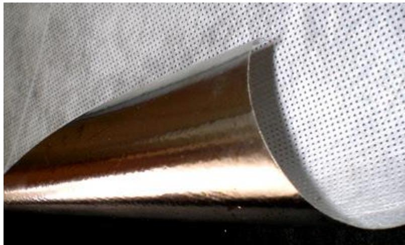
Комплекты теплоизоляции для емкостей, так же производятся с покрытием из комбинации двух достаточно давно известных на строительном рынке материалов - высокопрочной, нервущейся алюминиевой фольги и теплоотражающий, температуростойкий нетканый материал из полипропилена - с целью получения новых полезных свойств и устранения недостатков каждого из этих материалов.
