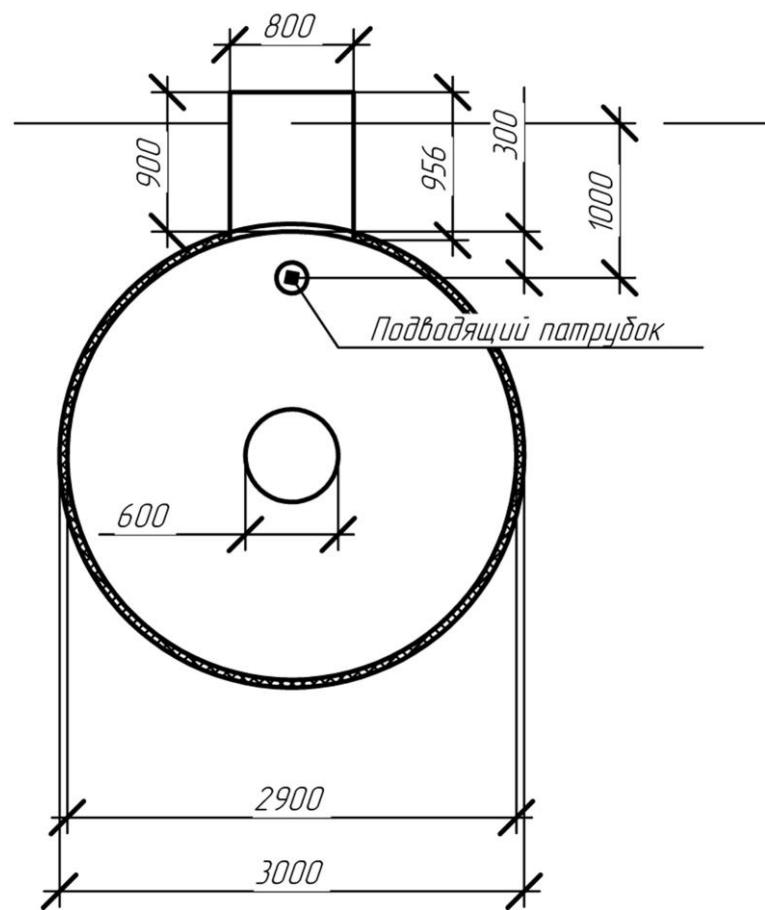
Для утепления емкости для сбора дождевых стоков на 75 м<sup>3</sup>, длиной 11,5 метра, с наружным диаметром 3 метра, с горловиной диаметром 800 мм, предлагаем 3 варианта комплектов теплоизоляции с различным покровным слоем:
