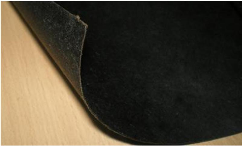
Бумага битумированная БУ-Б ГОСТ 515-77 - прочная, водонепроницаемая, с пропиткой битумом. Отличается высокой степенью водо- и воздухопроницаемости. Масса 1 м2 бумаги  $180 \pm 30$  г. Разрывная сила при растяжении не менее 17 кгс, водонепроницаемость по методу коробочек не менее 24 часов. Данный вариант силовой оболочки, водонепроницаем, при испытании под давлением 0,0005Мпа (0,005 кг/см<sup>2</sup>) в течение не менее 20ч. - не появляются признаки протекания воды.
