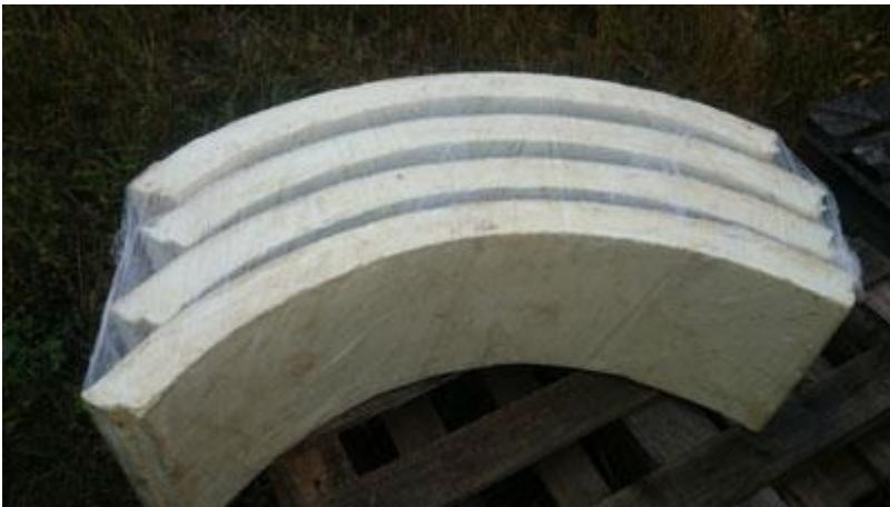
Комплект теплоизоляции ППУ ТИС для утепления емкостей любого диаметра состоит из нескольких сегментов (в зависимости от диаметра емкости) плотно прилегающих к телу емкости, и имеющие продольные замки благодаря которым исключается возникновение мостиков холода.
