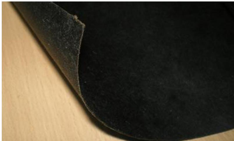
Бумага битумированная БУ-Б ГОСТ 515-77 - прочная, водонепроницаемая, с пропиткой битумом. Отличается высокой степенью водо- и воздухонепроницаемости. Масса 1 м<sup>2</sup> бумаги 180 ±30 г. Разрывная сила при растяжении не менее 17 кгс, водонепроницаемость по методу коробочек не менее 24 часов. Данный вариант силовой оболочки, водонепроницаем, при испытании под давлением 0,0005Мпа (0,005 кг/см<sup>2</sup>) в течение не менее 20ч. - не появляются признаки протекания воды.
