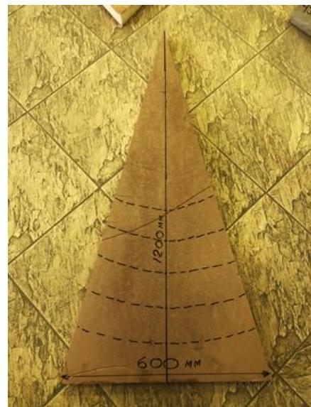
Комплекты теплоизоляции торцов для емкостей ППУ ТИС – это особо прочные теплоизоляционные сегменты из жесткого пенополиуретана, плотностью от 50 до 300 кг/м<sup>3</sup>, которые имеют покровный слой из технической бумаги, битумированной бумаги, стеклопластика, фольги или оцинковки. Стандартные комплекты для теплоизоляции торцов емкостей производятся с покровным слоем из битумированной или технической бумаги.
