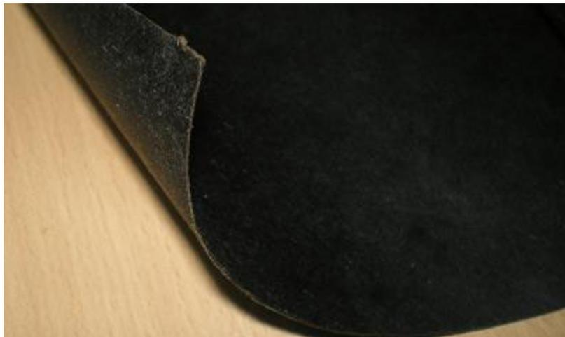
Бумага битумированная БУ-Б ГОСТ 515-77 - прочная, водонепроницаемая, с пропиткой битумом. Отличается высокой степенью водо- и воздухопроницаемости. Масса 1 м2 бумаги 180 ±30 г. Разрывная сила при растяжении не менее 17 кгс, водонепроницаемость по методу коробочек не менее 24 часов. Данный вариант силовой оболочки, водонепроницаем, при испытании под давлением 0,0005Мпа (0,005 кг/см2) в течение не менее 20ч. - не появляются признаки протекания воды.
