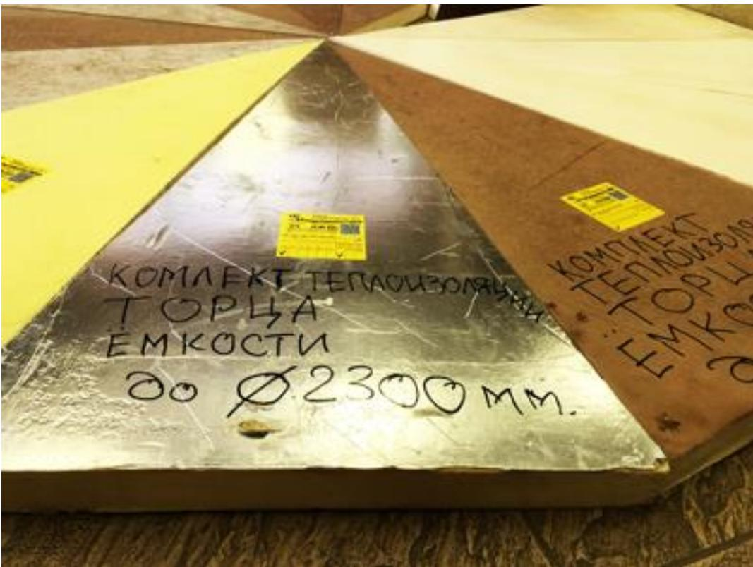
Завод ТИС производит 5 марок комплектов для теплоизоляции торцов емкостей:
