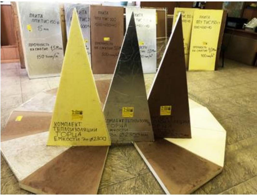
Для теплоизоляции торцов ёмкости используются комплекты сегментов в форме треугольника с различной толщиной теплоизоляции. Для теплоизоляции одного торца емкости применяется 13 треугольных сегментов из пенополиуретана.
