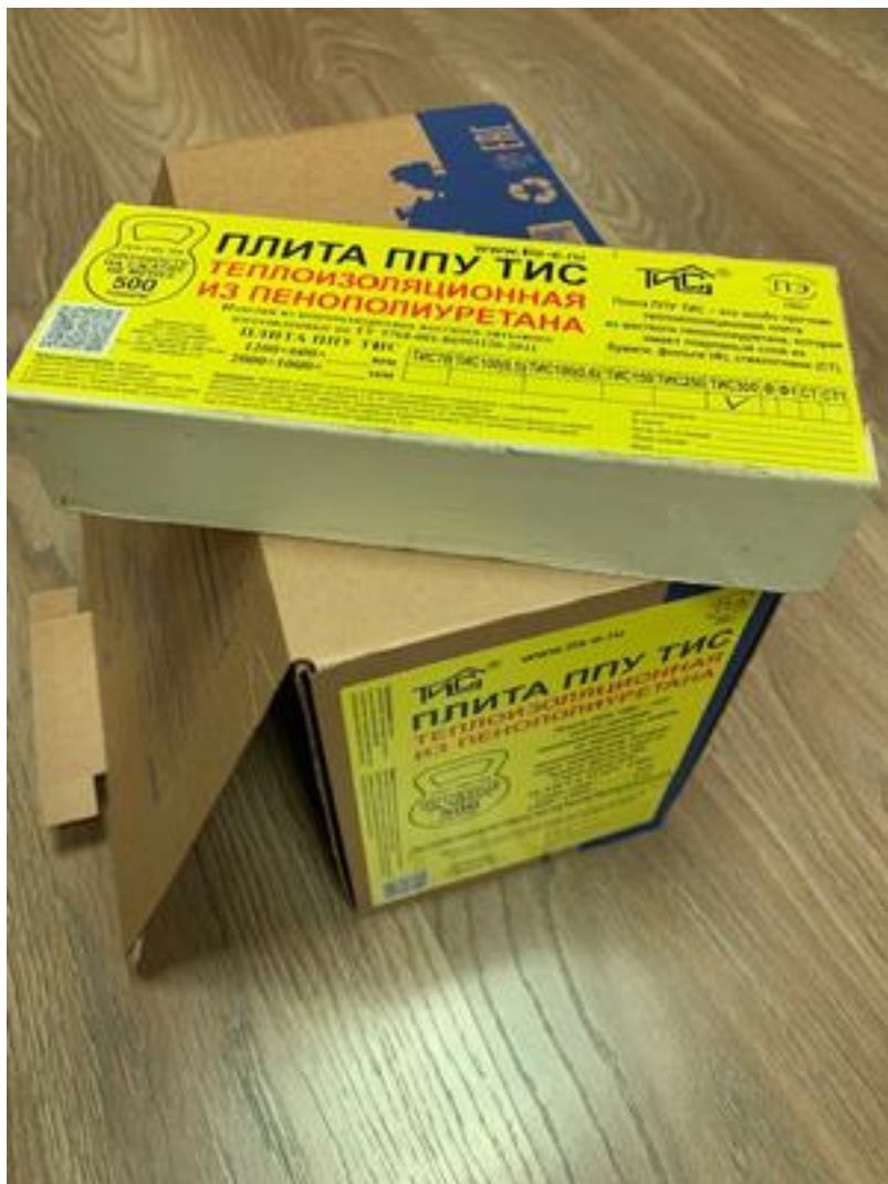
Фото образцов для испытания, размер 250*100*50 мм.
