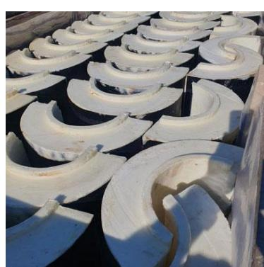
Теплоизоляция "ТИС"® для трубопроводов Скорлупа ППУ- - это полуциилиндры из жесткого пенополиуретана для утепления труб любого диаметра стандартных и нестандартных размеров с продольными и торцевыми замками в четверть. На внешней стороне теплоизоляции для
