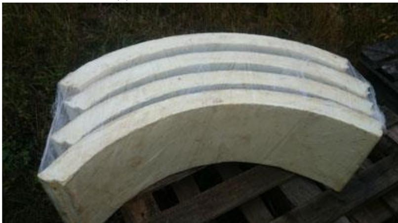
Комплекты теплоизоляции для емкостей ППУ ТИС – это особо прочные теплоизоляционные сегменты из жесткого пенополиуретана, плотностью от 50 до 300 кг/м<sup>3</sup>, которые имеют покровный слой из технической бумаги, стеклопластика, фольги или оцинковки.
