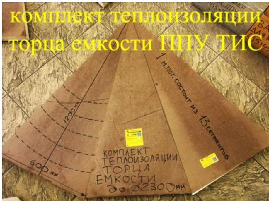
Комплекты теплоизоляции емкостей ППУ ТИС долговечны, при демонтаже их можно повторно использовать по своему прямому назначению.
