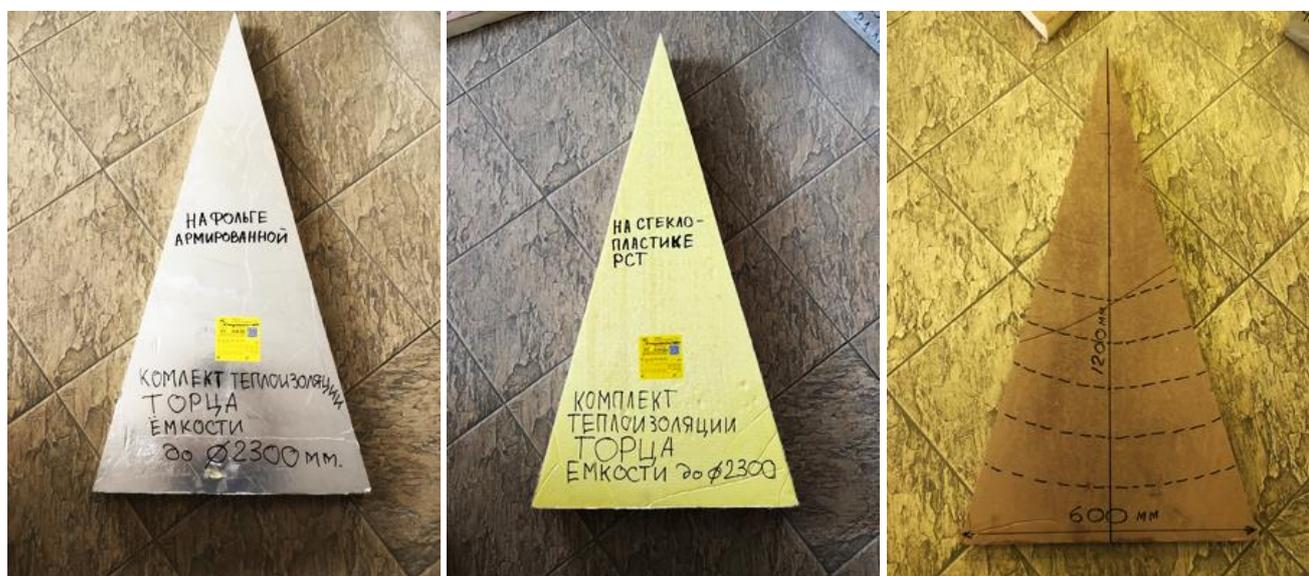
Комплекты теплоизоляции торцов для емкостей ППУ ТИС – это особо прочные теплоизоляционные сегменты из жесткого пенополиуретана, плотностью от 50 до 300 кг/м<sup>3</sup>, которые имеют покровный слой из технической бумаги, битумированной бумаги, стеклопластика, фольги или оцинковки.
