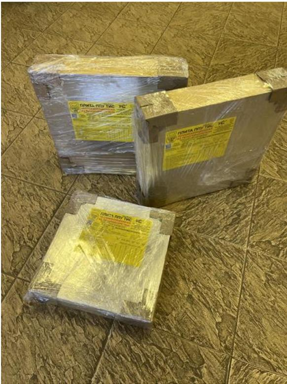
Изоляция ТИС 300 (плотность 320 кг/м<sup>3</sup>), была выбрана согласно технического задания, поскольку эти опоры должны обладать повышенной несущей способностью и выдерживать сверхнизкие температуры.
