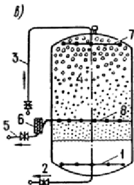
Черт. 30. Фильтры с плавающей пенополистирольной загрузкой
