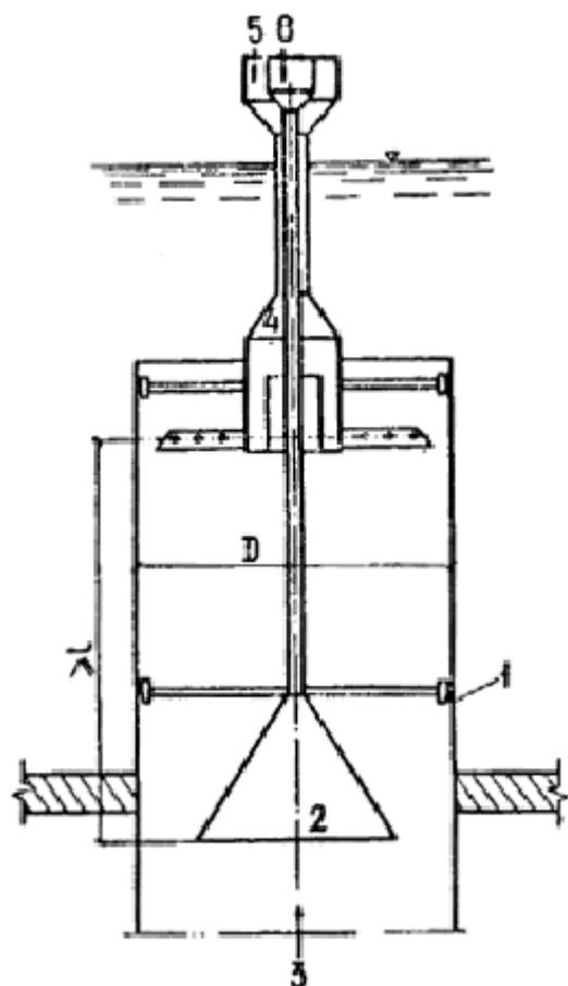
Черт. 6. Схема совмещения диффузорного и камерно-лучевого распределителей
