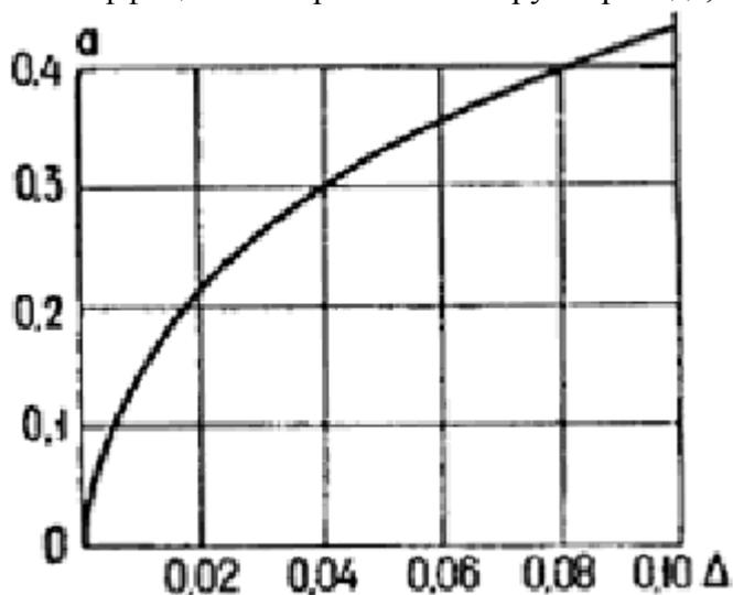
Черт. 24. Номограмма зависимости между неравномерностью распределения воздуха  $D$  и характеристикой трубопровода  $a$
