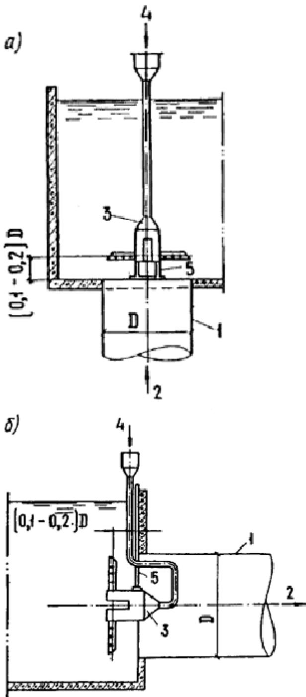
Черт. 4. Схемы установки камерно-лучевых распределителей (тип II)
