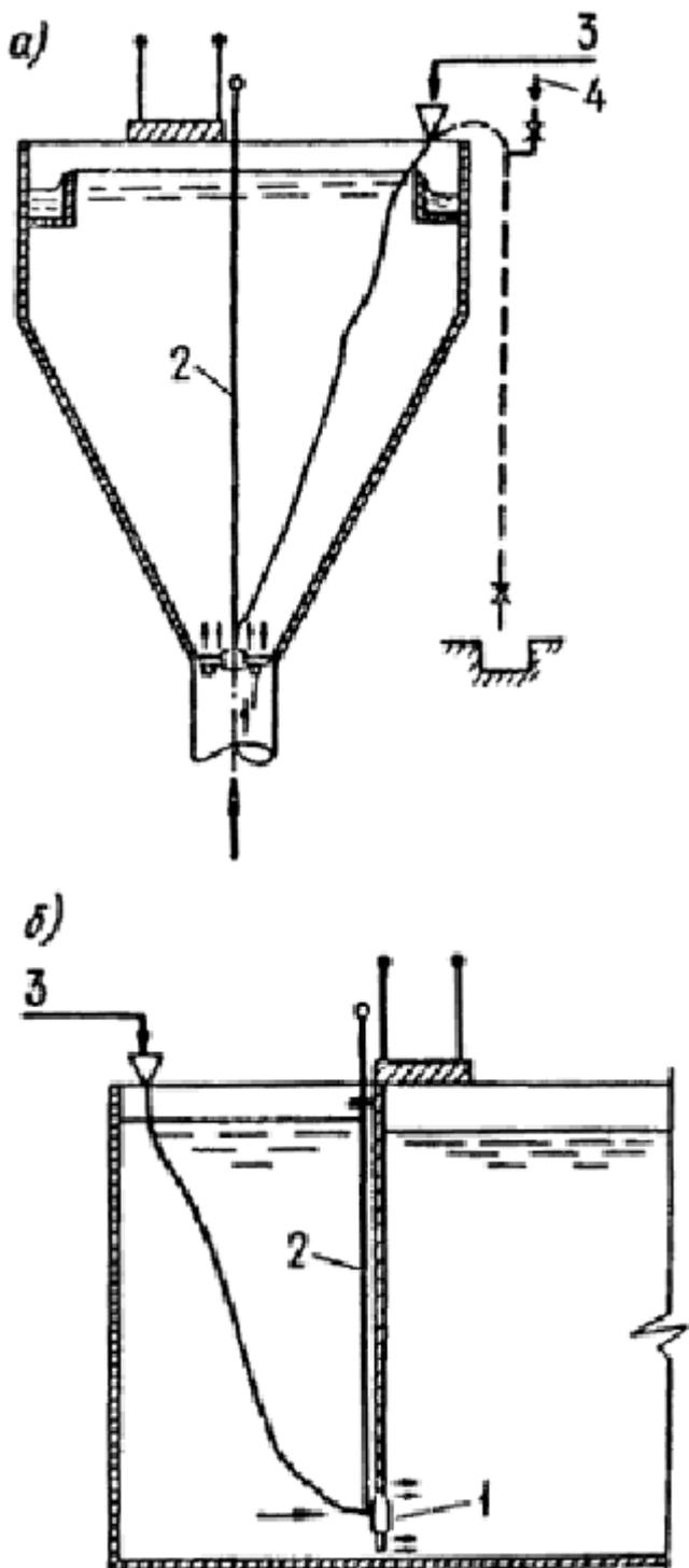
Черт. 1. Схема установки перфорированного распределителя коагулянта (тип I)
