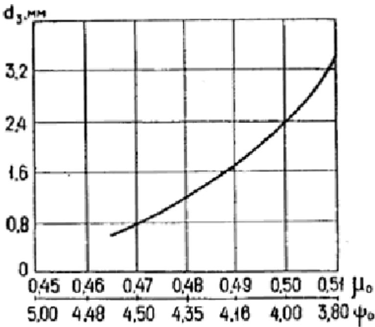
Черт. 25. Номограмма зависимости между коэффициентом  $\mu_o$  (или коэффициентом  $\psi_o$ ) и крупностью песчаной загрузки  $d_3$ . Коэффициент сопротивления  $\zeta$  следует определять по формуле
