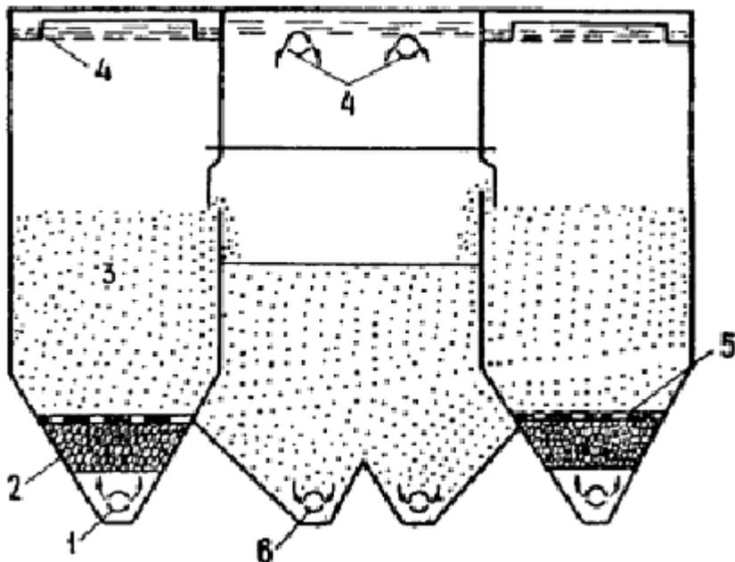
Черт. 12. Осветлитель с контактной камерой хлопьеобразования
