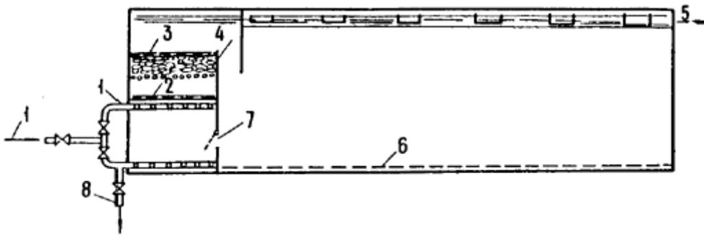
Черт. 11. Горизонтальный отстойник с контактной камерой хлопьеобразования
