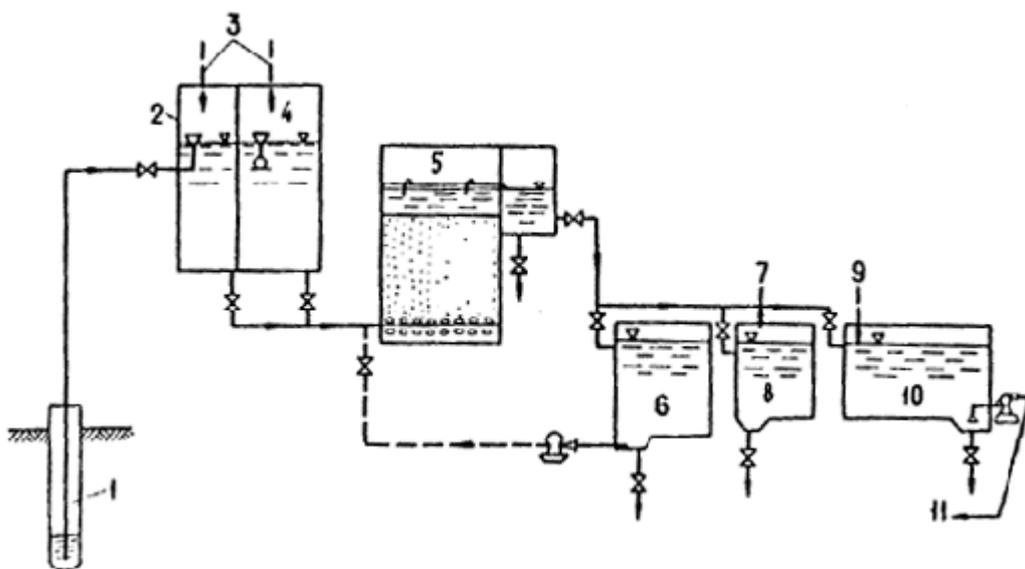
Черт. 41. Принципиальная схема работы станции обесфторивания воды
