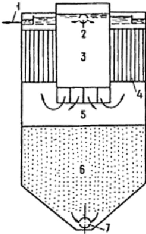
Черт. 13. Вертикальный отстойник, оборудованный тонкослойными блоками
