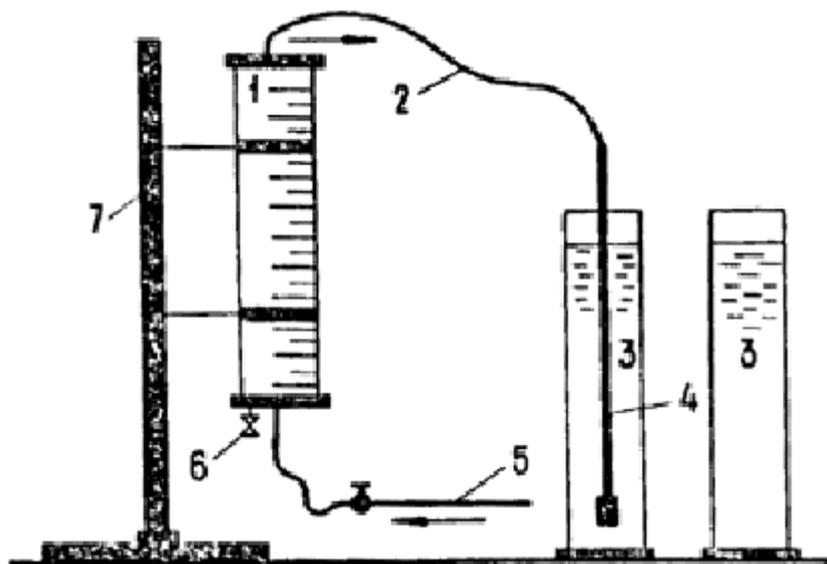
Черт. 9. Прибор для аэрирования воды в цилиндрах
