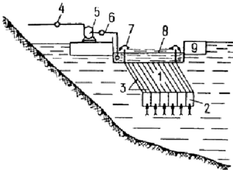
Черт. 34. Плавучий водозабор-осветлитель
