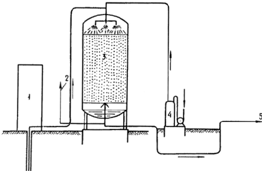
Черт. 36. Принципиальная схема обезжелезивания воды методом водовоздушного фильтрования
