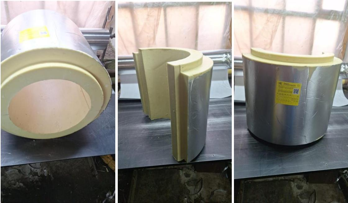
Крио вкладыш ППУ ТИС 300 для трубопровода диаметром 325 мм, длиной 450 мм., произведен с толщиной теплоизоляционного слоя 100 мм., покрытие фольга.
