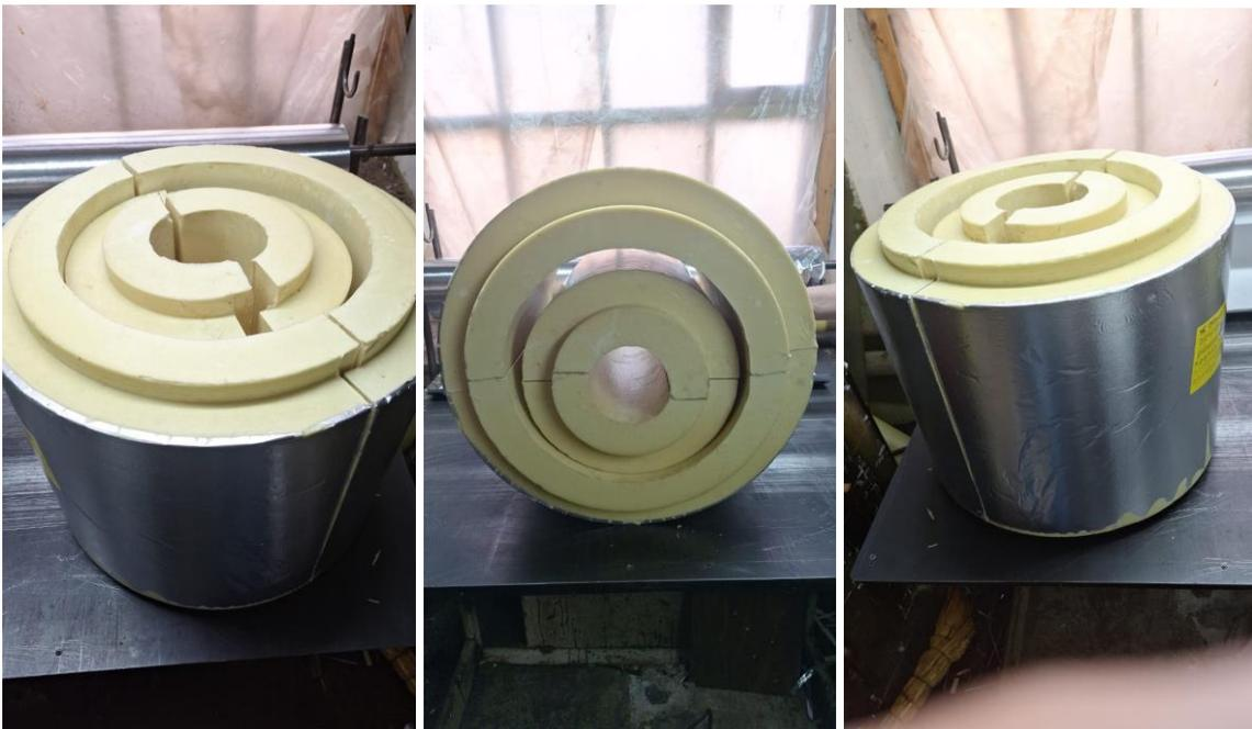
Изоляция ТИС 300 (плотность 320 кг/м<sup>3</sup>), была выбрана согласно технического задания, поскольку эти опоры должны обладать повышенной несущей способностью и выдерживать сверхнизкие температуры.
