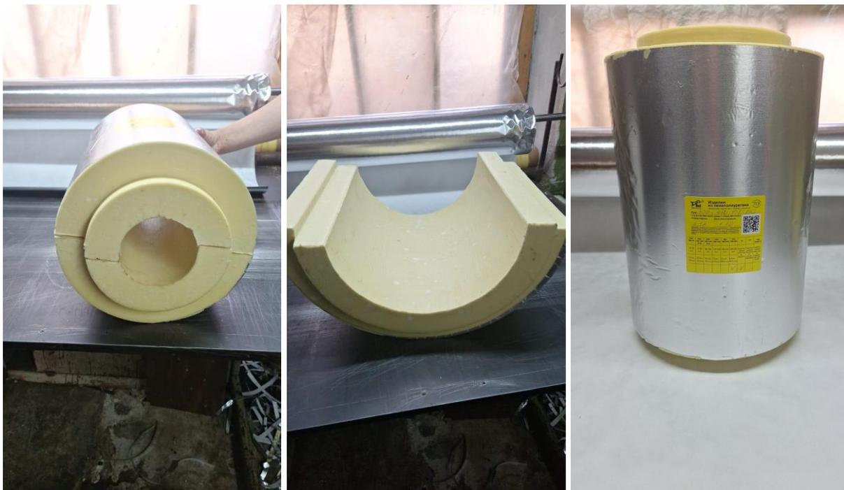
Крио вкладыш ППУ ТИС 300 для трубопровода диаметром 108 мм, длиной 450 мм., произведен с толщиной теплоизоляционного слоя 100 мм., покрытие фольга.
