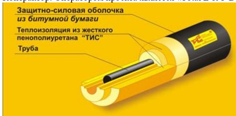
Для теплоизоляции нефтяной трубы с наружным диаметром 108 мм., была применена теплоизоляция марки ТИС100, в виде сегментов и полуцилиндров из жесткого пенополиуретана с покровным слоем из битумированной бумаги, с толщиной теплоизоляционного слоя 40 мм.
